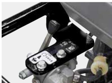
Единый рычаг дроссельной заслонки (Выкл: двигатель, подача топлива; регулировка дросселя).
